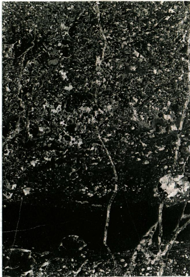
Abb. 7: Hauptdolomit (DS 86; Fundort: Neue Forststraße am Südostabhang der Koten 878-840, 640m Höhe). Die große, dunkle Komponente im unteren Teil des Bildes ist ein Lithoklast (wiederaufgearbeitete Algenmatte). Weiters sind Schalenreste nahe der Unterkante der Abbildung zu erkennen.
